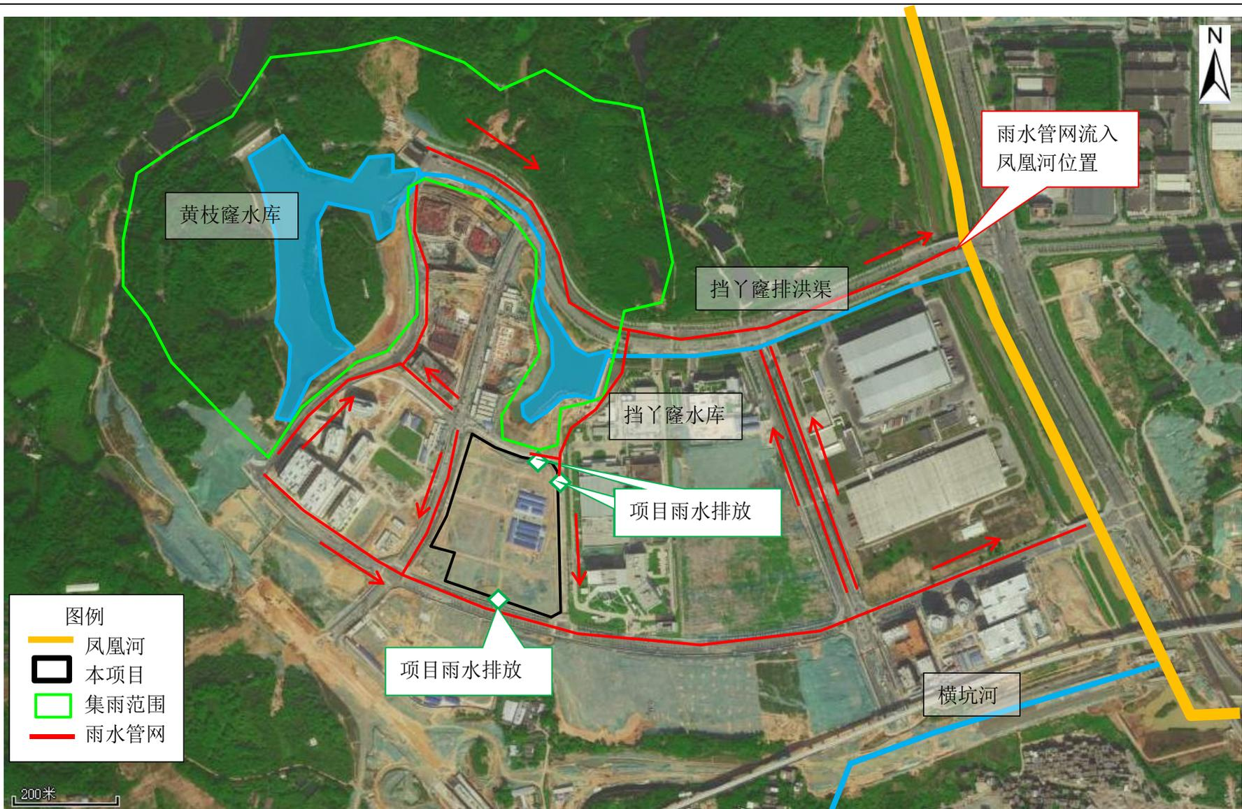
图6.3-1a 项目周边雨水管网图（来自《黄埔区给排水系统专项规划（2019-2035）图集》及现场实际建设情况）
