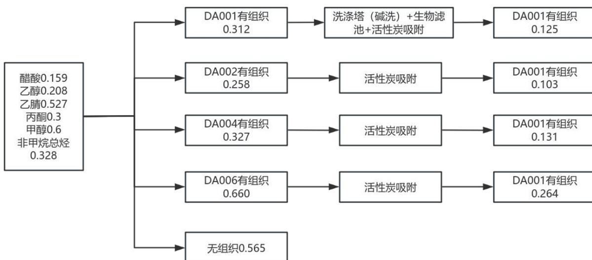
图4.2-8 项目VOCs平衡图 (t/a)
