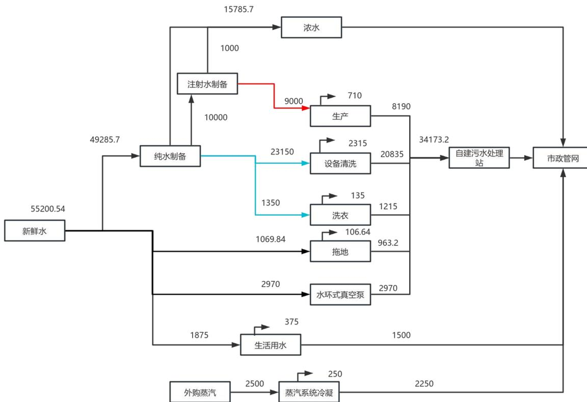
图4.2-9a 项目水平衡图 单位: t/a
